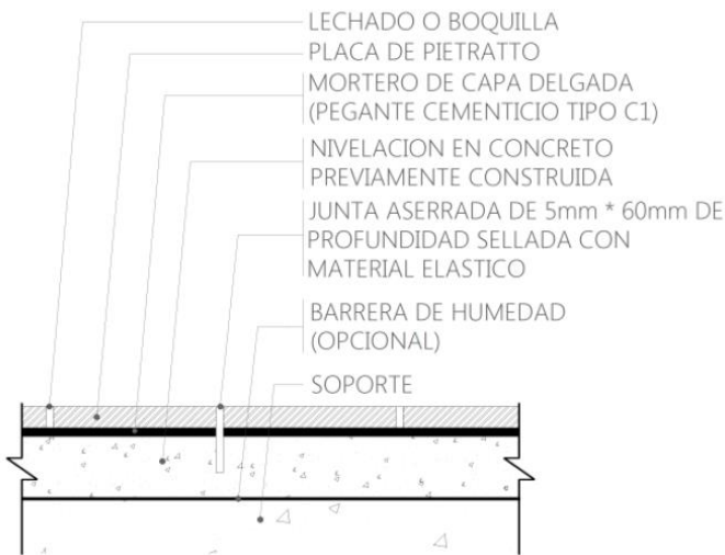
PIETRATTO CONSTRUIDO SOBRE NIVELACIONES PREVIAMENTE CONSTRUIDAS
