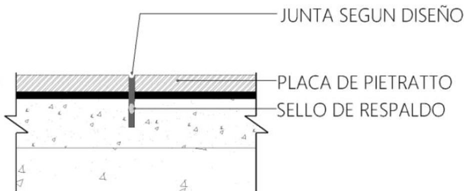
DETALLE CONSTRUCCION DE JUNTA ELASTICA
